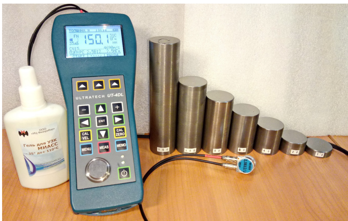
Рисунок 6 Средства УЗ контроля и комплект СОУЗ в процессе проведения измерений толщины
