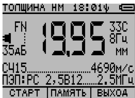
Рисунок 17 Вид экрана при измерении толщины образца № 02-18 СЧ15 Н20
