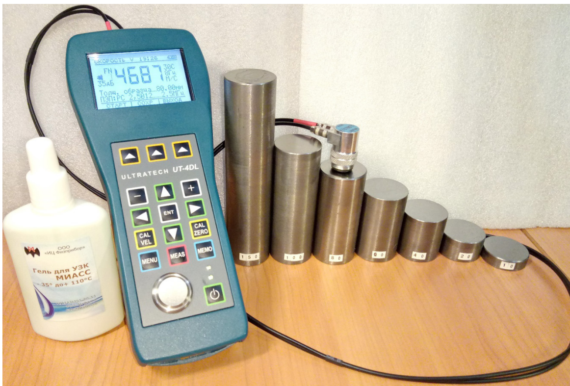
Рисунок 5 Средства УЗ контроля и комплект СОУЗ в процессе проведения измерений скорости
