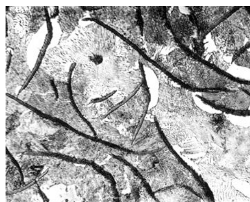
Рисунок 3 Микроструктура чугуна отливки с пластинчатым графитом (увеличение x135)
