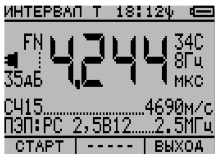
Рисунок 13 Вид экрана при измерении времени прохождения в образце № 02-18 СЧ15 Н20
