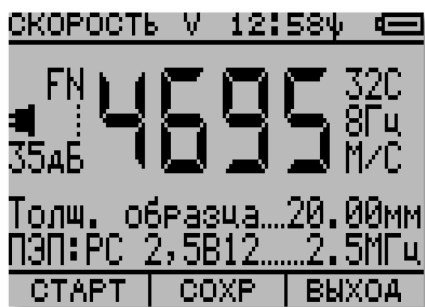
Рисунок 15 Вид экрана при измерении скорости УЗК в образце № 02-18 СЧ15 Н20
