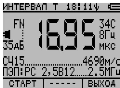
Рисунок 14 Вид экрана при измерении времени прохождения в образце № 02-18 СЧ15 Н80
