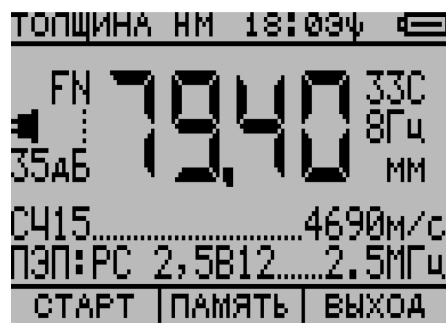
Рисунок 18 Вид экрана при измерении толщины образца № 02-18 СЧ15 Н80
